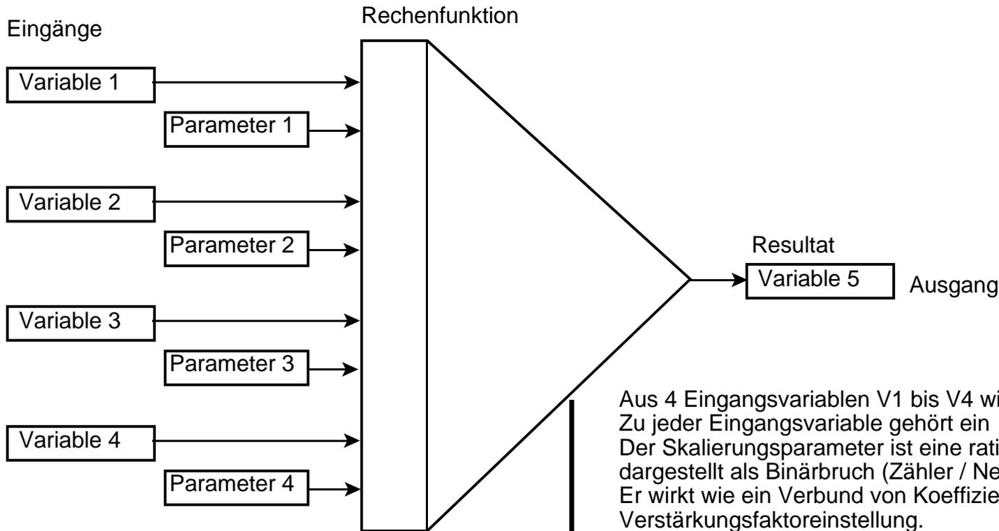
Aus 4 Eingangsvariablen V1 bis V4 wird ein Ergebnis gebildet. Zu jeder Eingangsvariable gehört ein Skalierungsparameter (P1 bis P4). Der Skalierungsparameter ist eine rationale Zahl, dargestellt als Binärbruch (Zähler / Nenner). Er wirkt wie ein Verbund von Koeffizientenpotentiometer und Verstärkungsfaktoreinstellung.
