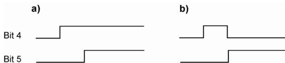
Abb. 3 Theorie und Praxis. a) Programmiersabsicht; b) der tatsächliche Signalverlauf an den Anschlüssen
