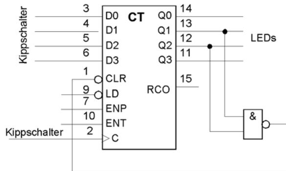
**Abb. 17** Jetzt wird von Null an gezählt, um eine bestimmte Zählweite zu erzwingen. Die Kippschalter an den Dateneingängen brauchen wir nicht. Sie können aber gleich dranbleiben (für die nachfolgende Aufgabe).
