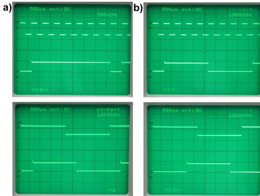
**Abb. 22** Der Johnsonzähler. a) Synchronimpulse; b) ein Flipflop Ausgang in Bezug auf den Takt; b) das zeitversetzte Schalten der Flipflopausgänge (zwei Beispiele).
