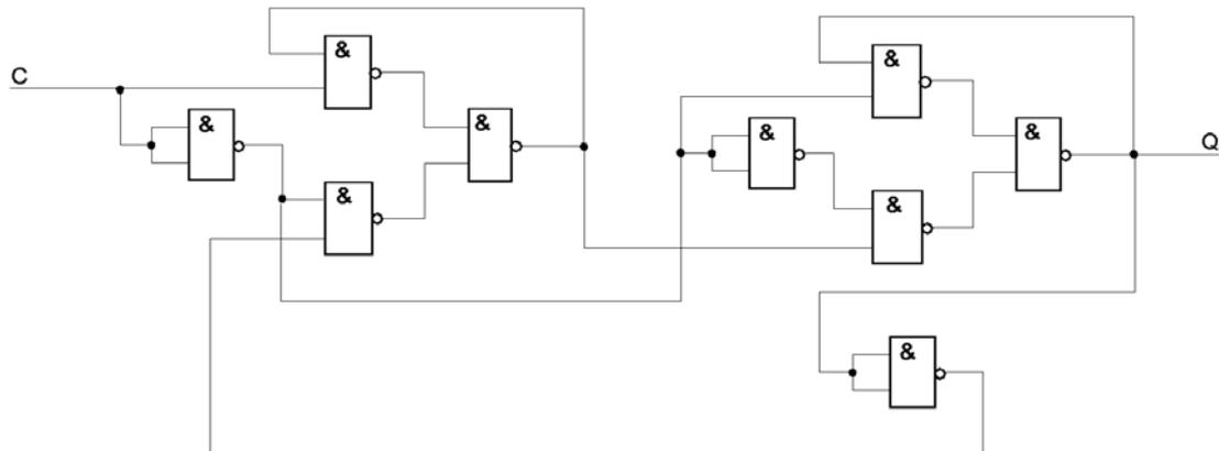
**Abb. 12** Das als 2:1-Teiler beschaltete D-Flipflop. Für den zusätzlicheh Negator einen dritten Schaltkreis 74ALS00 einsetzen.
