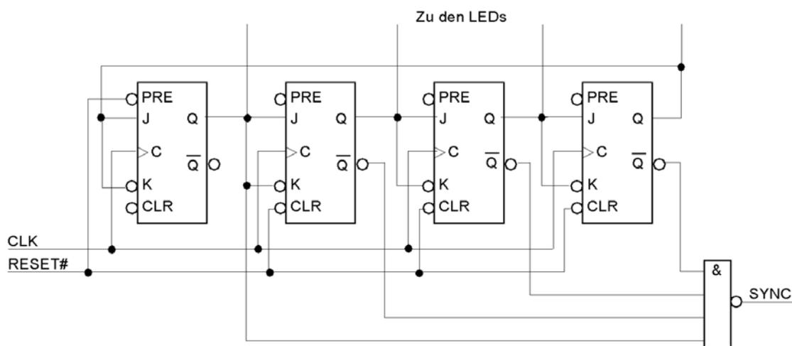
**Abb. 19** Die einfachste Ringzählerschaltung.
