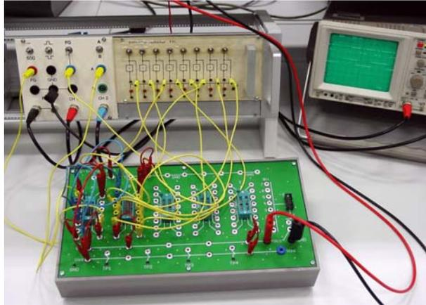
**Abb. 14** Der Versuchsaufbau. Mit den Kippschaltern wird das Impulsmuster eingestellt.
