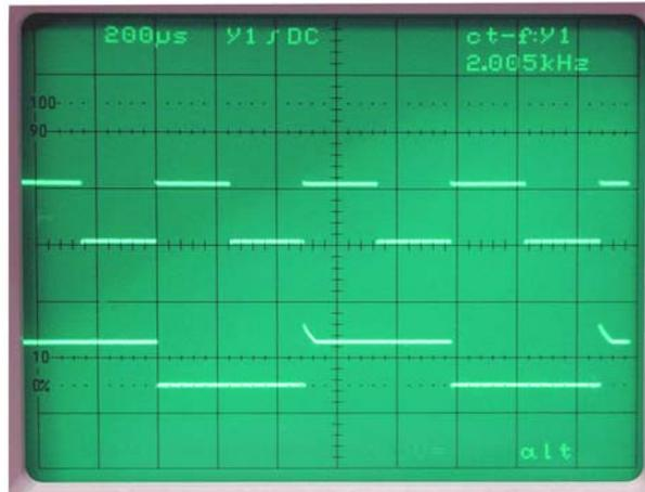
**Abb. 6** Das Flipflop als 2:1-Teiler. Oben der Takt, unten das Ausgangssignal. Die Spikes ergeben sich als Folge des einfachen Versuchsaufbaus (lange Kabel, keine richtige Masseebene usw.). Sie werden kleiner, wenn man das Signal mittels Tastkopf adaptiert.
