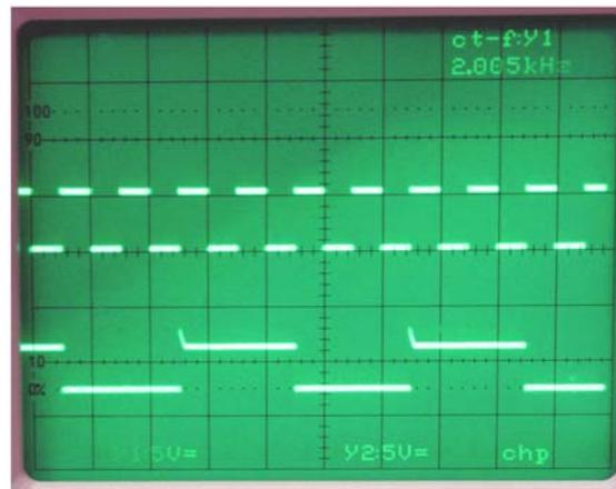
**Abb. 8** Das Flipflop als 4:1-Teiler. Oben der Takt, unten das Ausgangssignal. Ggf. am Zeitbasisknopf drehen, bis sich ein stabiles Bild ergibt.
