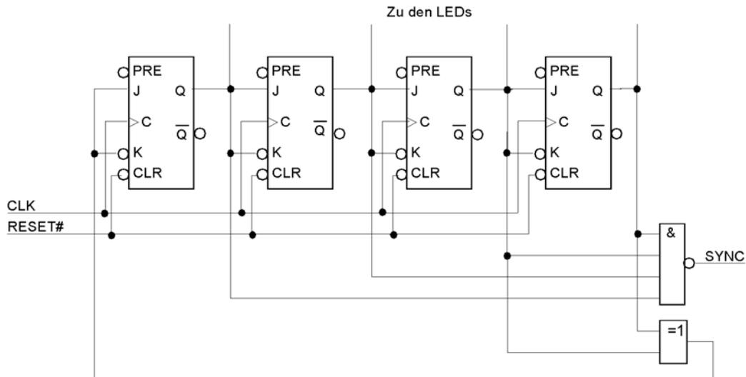
**Abb. 23** Ein Schieberegister mit maximaler Zykluslänge. Damit es anschwingt, ist die RESET-Leitung bei wenigstens einem Flipflop auf den S-Eingang umzulegen. Da die Belegung 0H (alles Nullen) nicht vorkommt, wird das SYNC-Signal bei Belegung FH (alles Einsen) abgegeben.
