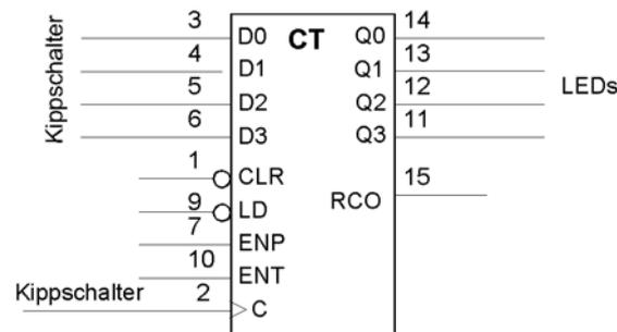
**Abb. 16** Vorerprobung eines Binärzählers.
