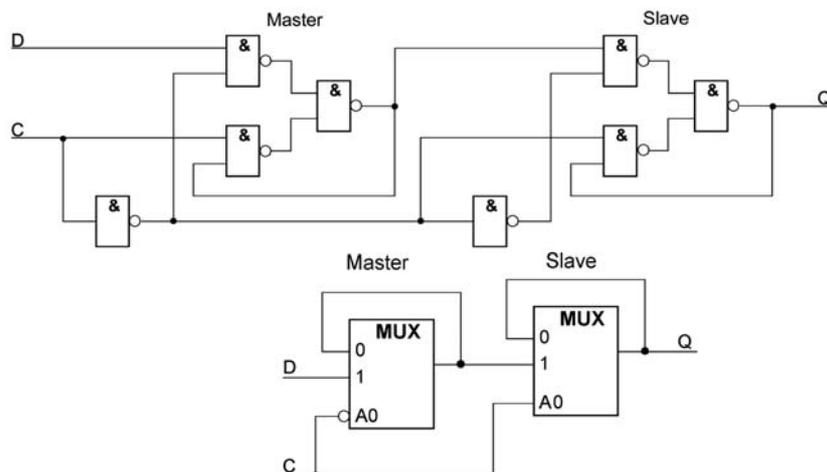
Beide Darstellungen gelten als richtig. Ist das Taktsignal Low, folgt der Ausgang des Masters dem Eingang D. Am Ausgang des Slaves ändert sich nichts (Speicherwirkung). Schaltet das Taktsignal auf High (Low-High-Flanke), so wird der Master gesperrt und speichert den jeweils aktuellen Pegel des D-Eingangs. Der Slave hingegen wird aktiv und reicht das Ausgangssignal des Masters (= den gespeicherten Wert) zum Ausgang Q durch.
