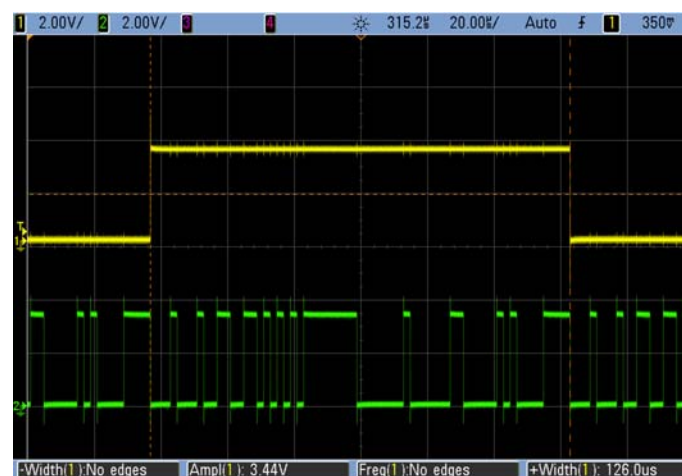
Abb. 36 Lineares rückgekoppeltes Schieberegister (LFSR). 8 Bits, verringerte Zykluslänge.
