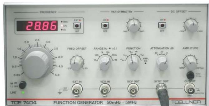
**Abb. 26** Die Impulse kommen vom Synchronsignalausgang des Funktionsgenerators. Sie haben eine passende Amplitude (TTL-Pegel).
