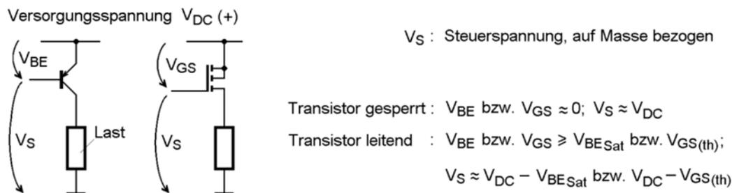
**Abb. 4.45** High Side Drive mit PNP- und P-Kanal-Transistoren.
