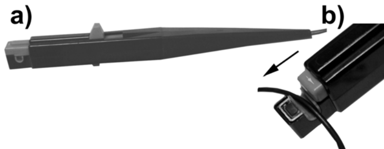
Abb. 3.4 Präzisions-Strommeßzange mit transformatorischem Wandler und Schiebemechanismus (Tektronix). a) Ansicht; b) geöffneter Kern mit eingelegtem Draht
