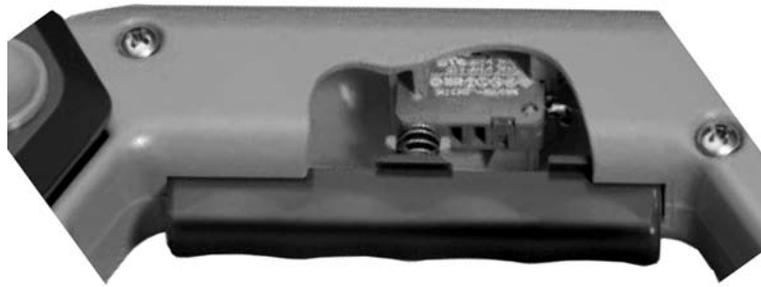
**Abb. 4.46** Mikroschalter im Einsatz. Hier in einem Handgriff (nach [4.13]).
