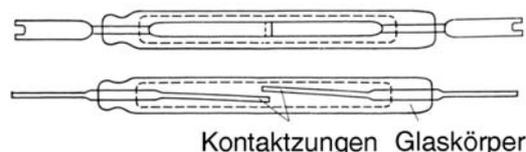
**Abb. 4.60** Ein typischer Reedkontakt. Schaltweise: SPST NO.
