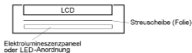
Abbildung 2.8 Hintergrundbeleuchtung von LCD-Anzeigen
