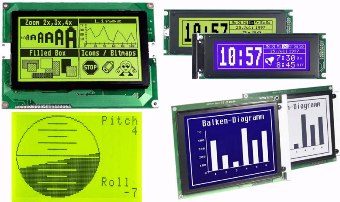
LCD-Graphikdisplays mit Busschnittstelle. Graphik ist auszuprogrammieren
