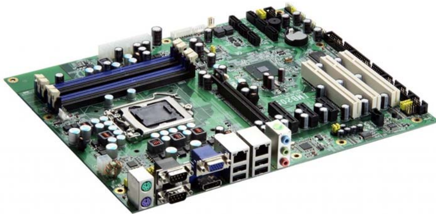
Abb. 2.1 Eine Hauptplatine. Hier ein Motherboard für Industrie-PCs im Formfaktor ATX.
