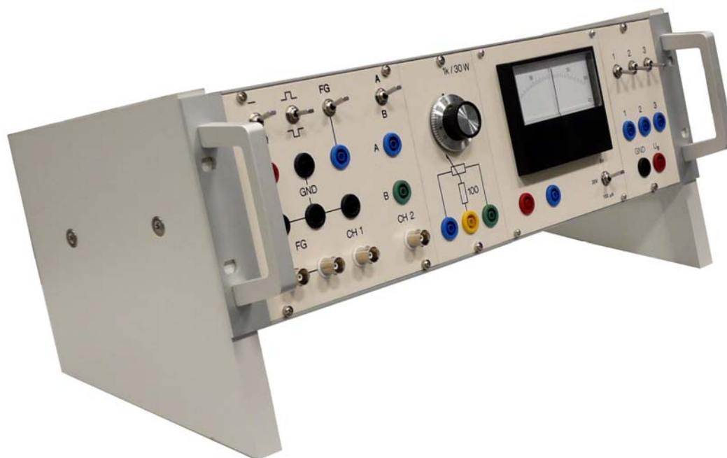
Abb. 2.55 Ein Einbaurahmen (Geräteträger) für Experimentierzwecke. Es ist ein einfacher Baugruppenträger 3 HE mit zwei Aufstellern.
