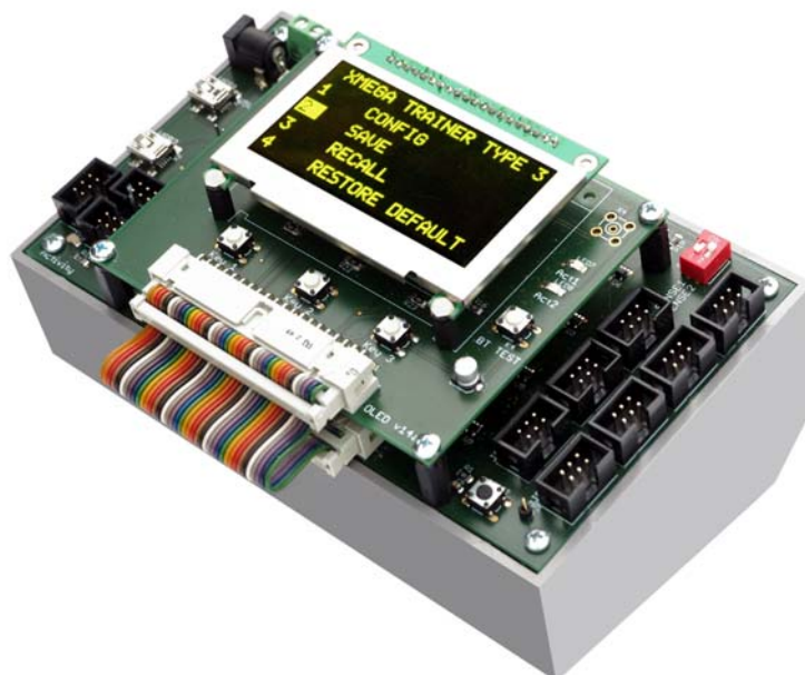
Abb. 2.46 Ein Modul mit Universanschluss und einer aufgesetzten Bedien- und Anzeigeplatine.
