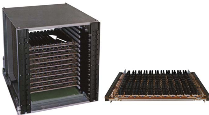
Abb. 2.18 Der Prozessorkern eines Mainframes (Amdahl). Links der fertig montierte Turm, rechts eine der Leiterplatten. Eine Leiterplatte trägt etwa 200 hochintegrierte Schaltkreise, jeder mit eigenem Kühlkörper. Der weiße Pfeil soll andeuten, dass im Betrieb Kühlluft durch den Stapel geblasen wird.
