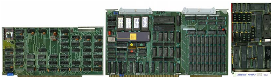
Abb. 2.10 Steckkarten mit Digitalschaltungen (Control Data Corporation). Links eine einfache Leiterplatte, rechts ein sog. Cordwood-Modul. Zwei Platinen übereinander, die Transistoren und Widerstände dazwischen. Die Pfeile zeigen auf Messpunkte am Rand.
