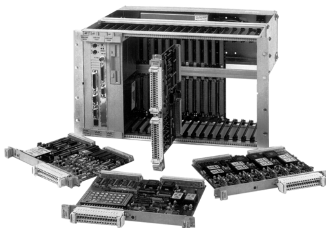
Abb. 2.7 Ein System, das auf dem VME-Bus beruht.
