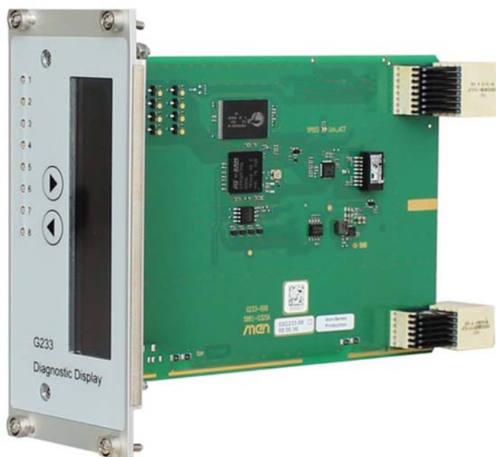
Abb. 2.13 Leiterplatte mit Frontplatte (MEN GmbH).
