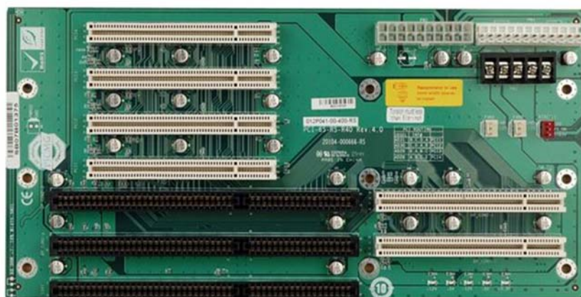
Abb. 2.4 Beispiel einer passiven Busplatine nach PICMG. Zwei SBC-Slots ermöglichen eine flexible Bestückung. Die SBCs haben eine beträchtliche Bauhöhe. Sie überdecken wenigstens noch einen benachbarten Slot. Steckt der SBC im unteren Slot, so überdeckt er den ISA-Slot darunter, lässt aber alle PCI-Slots frei, steckt er im oberen Slot, überdeckt er den PCI-Slot darüber, lässt aber zwei ISA-Slots frei.
