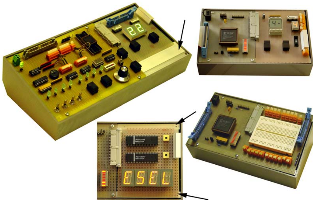
Abb. 2.36 Module zum Gegeneinanderstecken (Labormuster). Das jeweils linke Modul ist im Gehäuse befestigt, das jeweils rechte wird gesteckt. Es gibt verschiedene Übungsmodule, die an Mikrocontroller, CPLDs usw. angeschlossen werden können. Die Pfeile zeigen auf Schienen aus Aluprofil, auf denen die Module aufliegen.
