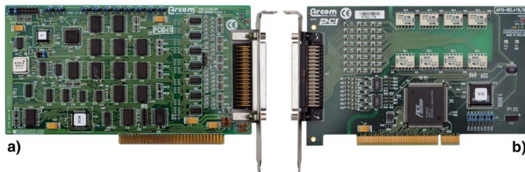
Abb. 4.23 Steckkarten für industrielle Anwendungen. a) ISA, b) PCI.
