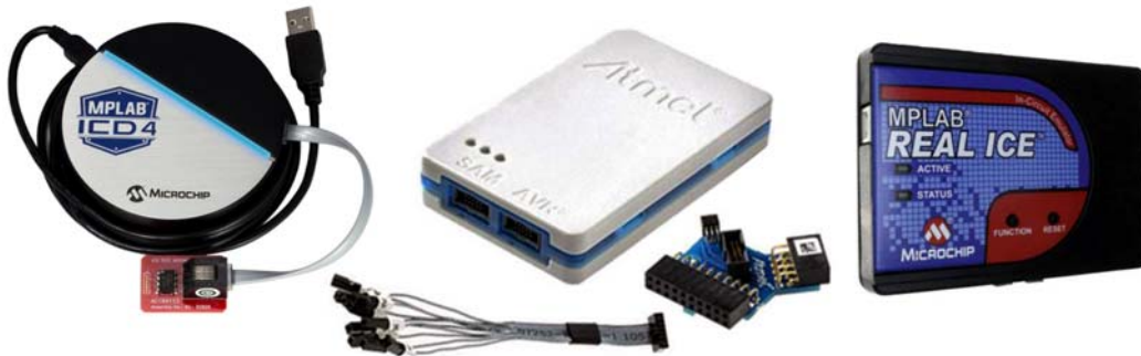
Abb. 7.9 Geräte zum Debugging (eine kleine Auswahl). Sie sind an einen PC und an das Zielsystem anzuschließen. Zu jedem dieser Geräte gibt es ein Sortiment an Adaptern und Kabeln für die verschiedenen Debuggingschnittstellen (JEDEC, PDI, debugWire usw.). ICD = In Circuit Debugger, ICE = In Circuit Emulator.
