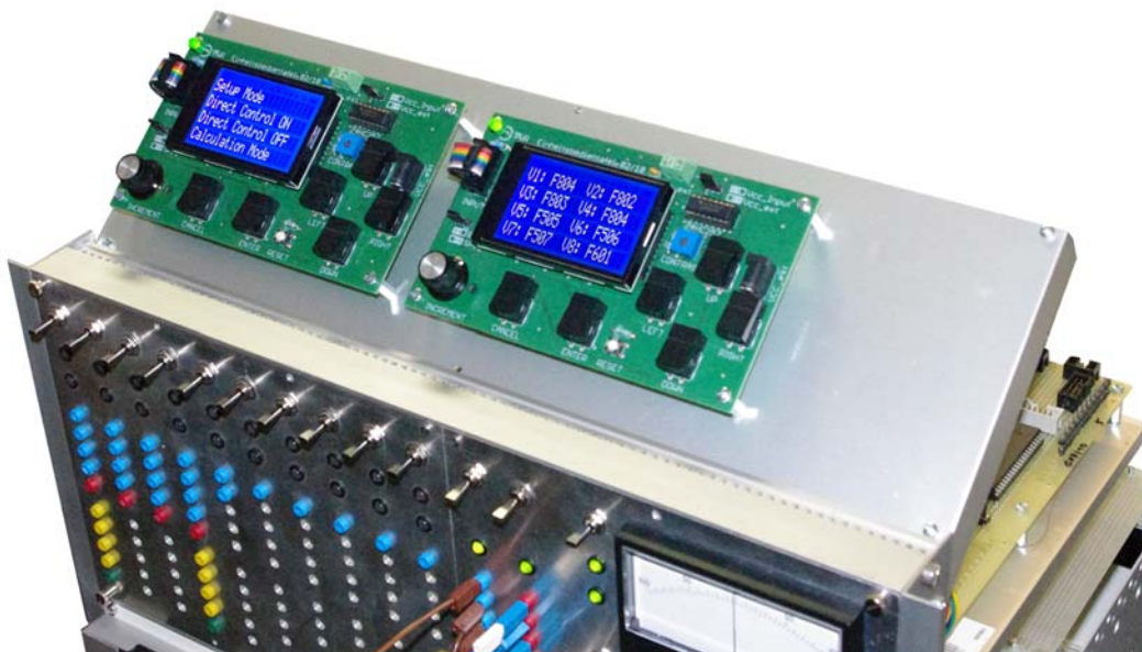
Abb. 6.6 Sechs Bedienkonsolen sind etwas unübersichtlich. Nachdem die größten Fehler beseitigt sind, sollten zwei ausreichen. Sie wurden hier auf eine Frontplatte montiert, die zum Inbetriebnehmen und Fehlersuchen an der Maschine befestigt wird (Inbetriebnahmehilfsgerät).
