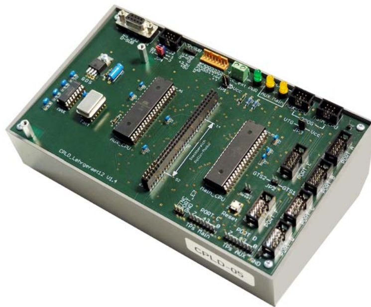
Abb. 7.11 Ein Ausführungsbeispiel – das CPLD-Lehrgerät 12. Zwei Mikrocontroller, 56 frei programmierbare Signale. Vorzugsweise Nutzung als quasistatischer Tester oder Peripherienachbildung. Anschluss der zu testenden Einrichtungen über Wannienstifteleisten oder durch Aufstecken auf den PC/104-Steckverbinder in der Mitte der Platine.
