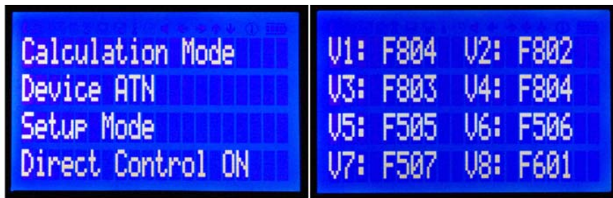
Abb. 6.7 Zwei Anzeigebeispiele. Links die letzten vier Maschinenzustände. Ausgabe nach Art einer Protokollschreibmaschine (Eintragen in die unterste Zeile, nachdem der Text hochgerollt wurde). Rechts werden die Werte von acht Variablen hexadezimal angezeigt.
