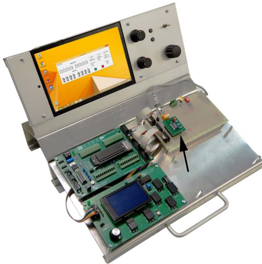
Abb. 6.18 Dem PC gegenüber so tun, als wäre eine USB-Tastatur angeschlossen. Hier im Experiment. Der Schaltkreis (Pfeil) kann ein angeliefertes Bitmuster in einen Tastaturcode umsetzen und an den PC liefern. Das Bitmuster wird von einem Mikrocontroller erzeugt.
