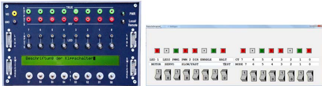
Abb. 6.10 Bedien- und Anzeigeelemente beschriften. Links Kippschaltergerät mit LCD-Anzeige. Beschriftungseingabe über Bedienterminal. Rechts ein Bedien- und Beschriftungsprogramm.
