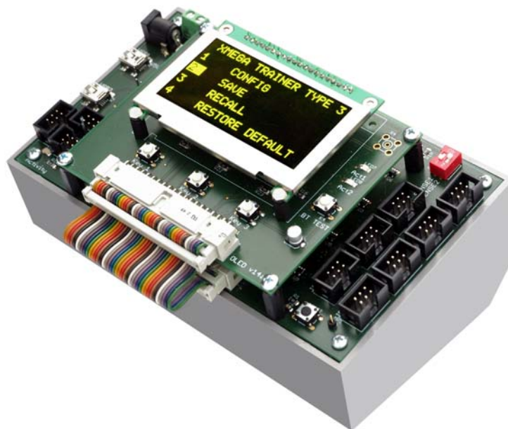
Abb. 8.28 Xmega-Trainer Typ 3. Ansicht mit aufgesetzter Bedien- und Anzeigeplatine (OLED-Display).
