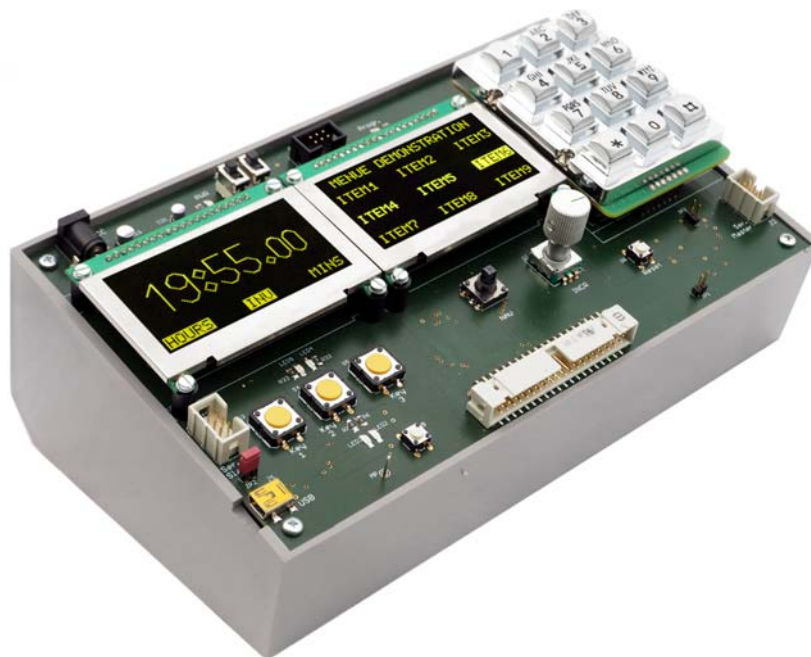
Abb. 8.34 All-in-One-Gerät Typ 2. Ansicht. Hier mit einem etwas aufwendigeren Tastenfeld (Keypad). Es wurde eingesetzt, weil die Tasten auch mit Buchstaben beschriftet sind (Telefontastatur). Somit kann über dieses Tastenfeld auch Text eingegeben werden.
