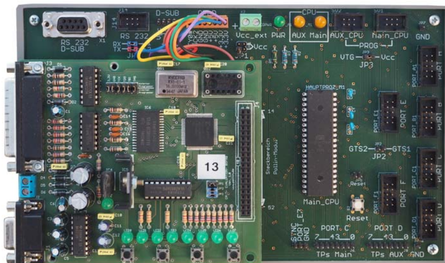
Abb. 8.18 CPLD-Lehrgerät 12 mit CPLD-Modul Typ P (CPLD-Evaluation-Board der Fa. Pollin, bestückt mit einem 40-poligen PC/104-Steckverbinder). Zusatzkabel für Anschluss an den Erweiterungssteckverbinder. Hierüber wird das Lehrgerät mit Betriebsspannung versorgt.
