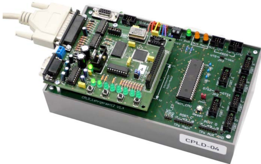
Abb. 8.17 CPLD-Lehrgerät 12. Ansicht mit aufgestecktem CPLD-Modul (Pollin) und Parallelport-Kabel zu CPLD-Programmierung.
