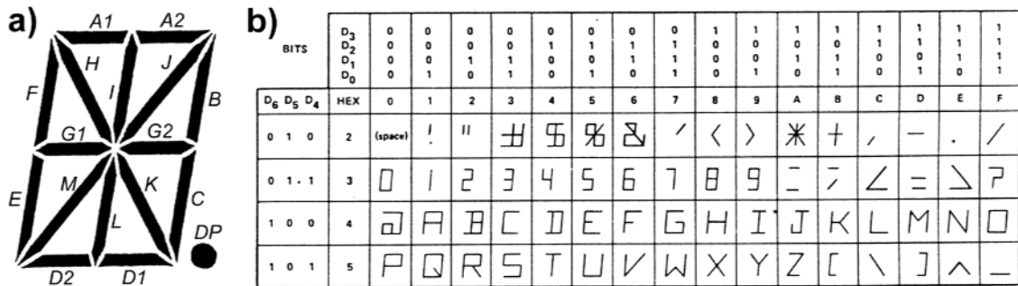
Abbildung 8.1.19 16-Segment-Darstellung. a) Segmentanordnung, b) Zeichensatz (nach: Hewlett-Packard)
