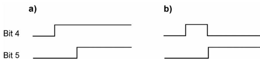
Abb. 2.3 Theorie und Praxis. a) Programmierabsicht; b) der tatsächliche Signalverlauf an den Anschlüssen
